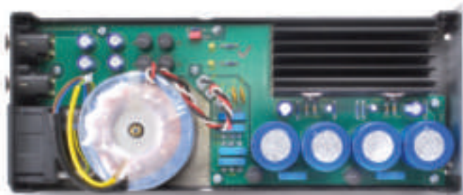
L'alimentatore è dotato di un toroidale di grande capacità e da sezioni di livellamento e prima stabilizzazione che è riduttivo definire surdimensionate.
